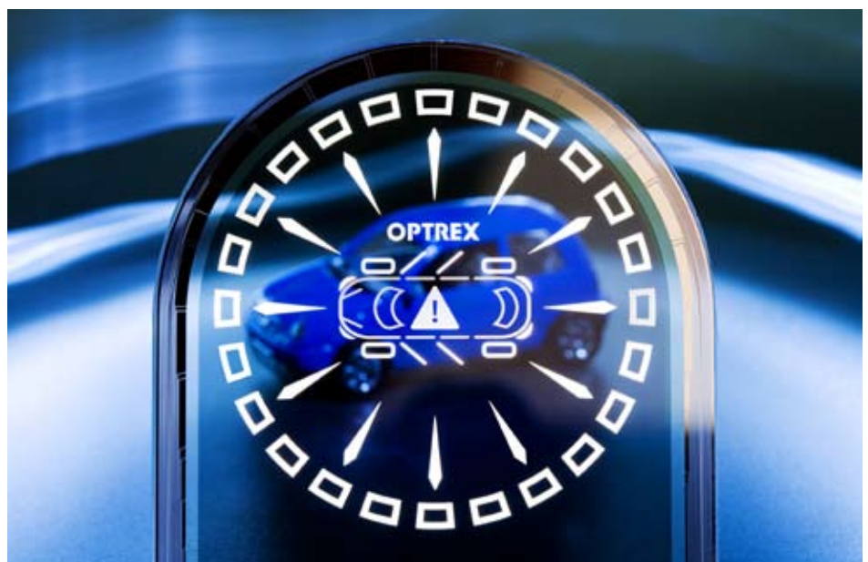
Abb. 1: Transparentes Anzeigebauelement (in Kooperation mit Optrex Europe)
