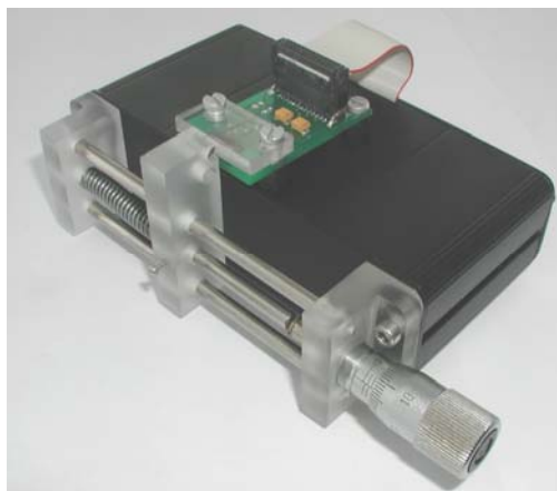
Abb. 4: Demonstrator-Box mit Mikrometerschraube, ADC, USB-I/F und montiertem HLA32-PCB (CEK)
